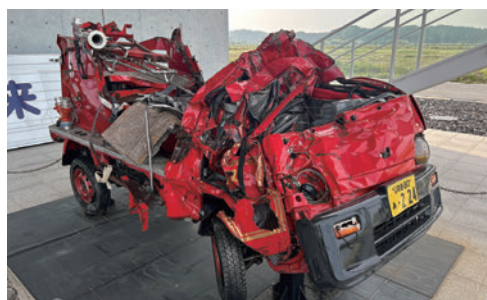
津波で大きく変形した消防車
